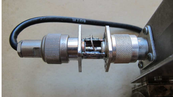
Le court circuit connecté à la cavité
