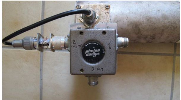
L'ensemble circulateur, court-circuit, cavité
