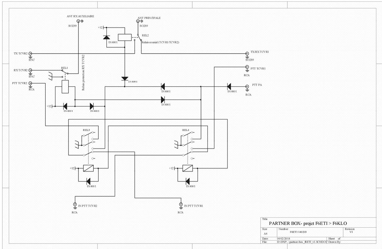
PTT TCVR1 actionne REL4 (empêche PTT TCVR2, active sortie PTT TCVR1 et PA, actionne REL1 (protection RX antenne auxiliaire),
